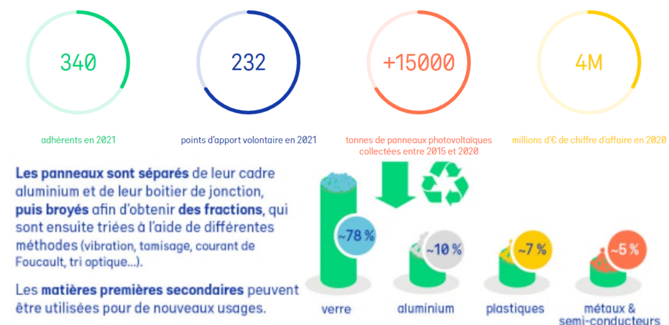
Figure 98 : Le traitement des panneaux photovoltaïques (source : Soren, 2022)
